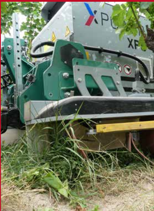
Als Hecklösung wird der XPS auf einen hydraulischen Rahmen montiert.
